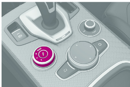
Selector del sistema Alfa DNA
