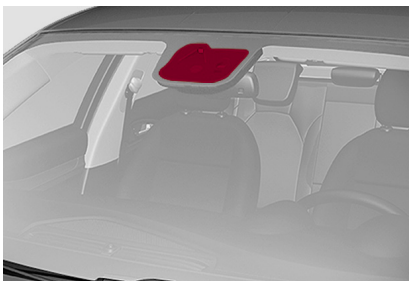
Ubicación de la cámara del parabrisas
