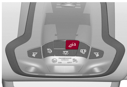
Botón de protección antilevantamiento
