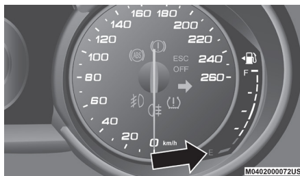
Medidor de nivel de combustible
