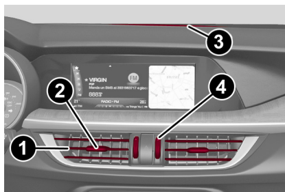
Ventilación de aire central
