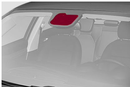
Ubicación de la cámara del parabrisas
