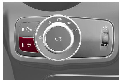
Botón de desactivación del START&STOP
