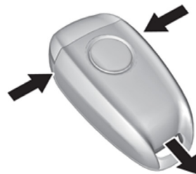
Retiro de la cubierta del transmisor
