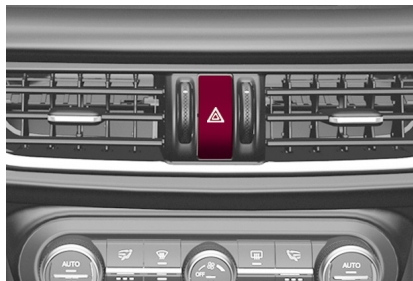
Interruptor de las luces de emergencia
