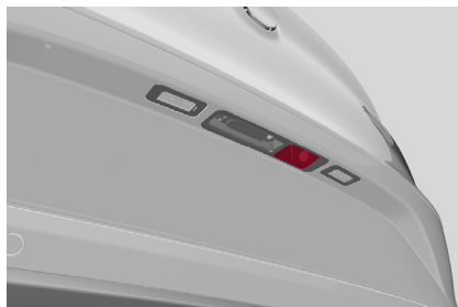
Ubicación de la cámara de reversa
