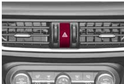
Interruptor de las luces de emergencia
