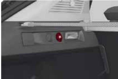
Toma de corriente del área de carga
