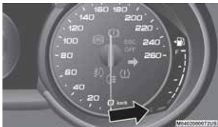
Medidor de nivel de combustible
