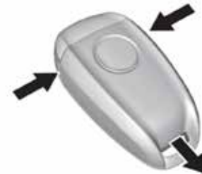
Retiro de la cubierta del transmisor
