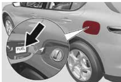
Etiqueta de la compuerta de combustible
