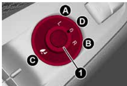
Control eléctrico del espejo
