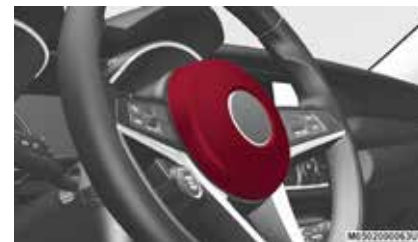
Bolsa de aire del conductor
