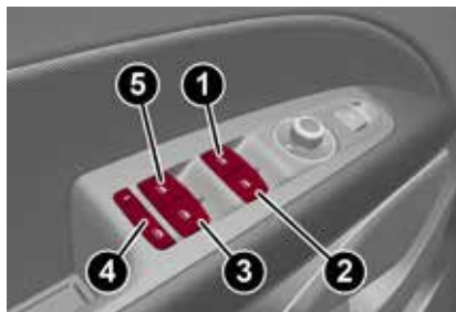
Interruptores de las ventanas
