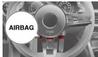
Ubicación de la bolsa de aire para rodilla del conductor / Ubicación de la almohadilla de la rodilla
