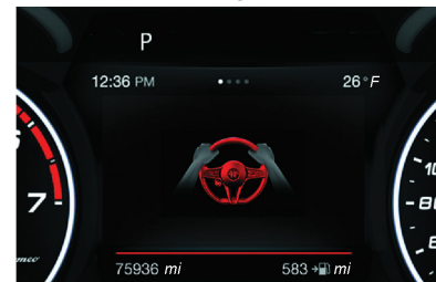
Pantalla de presencia de manos en el volante no detectada (de 6 a 15 segundos)
