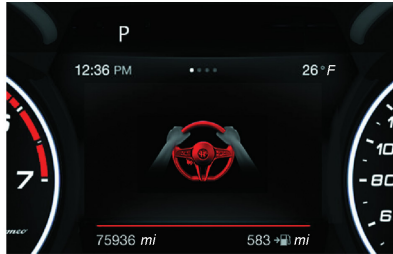
Pantalla de no detección de presencia de manos en el volante (de 6 a 15 segundos)
