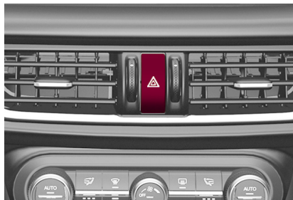
Interruptor de las luces de emergencia
