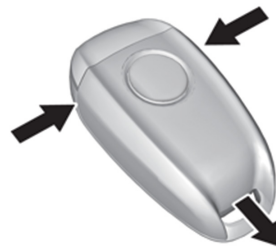
Retiro de la cubierta del transmisor
