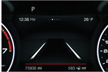
Pantalla de no detección de presencia de manos en el volante (por hasta 6 segundos)
