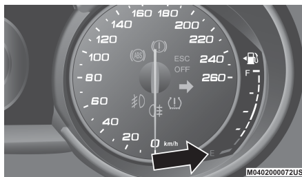
Medidor de nivel de combustible
