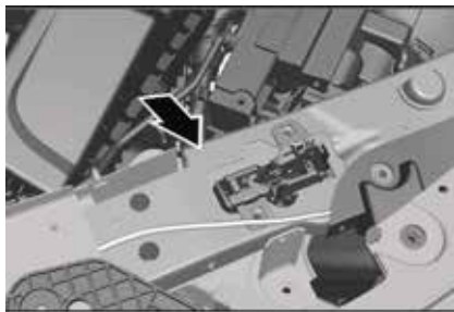
Ubicación de cubierta de protección
