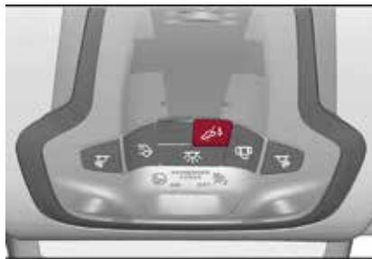
Botón de protección antilevantamiento
