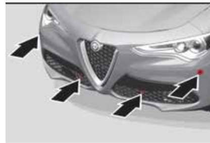
Ubicación de los sensores delanteros
