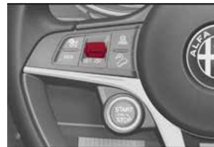
Interruptor SET para velocidad del HDC
