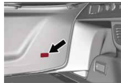
Ubicación del liberador de la compuerta levadiza
