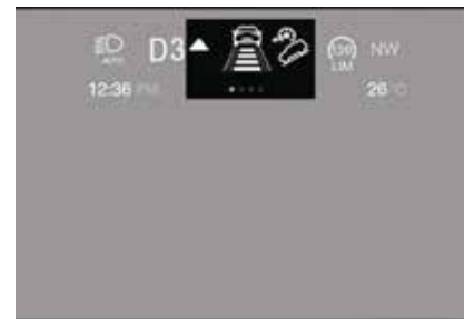
Testigo del HDC
