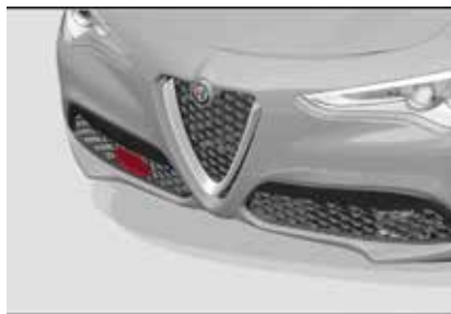
Ubicación del radar en la defensa delantera
