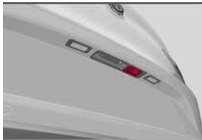
Ubicación de la cámara de reversa
