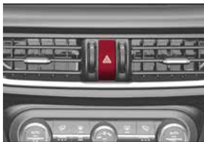
Interruptor de las luces de emergencia
