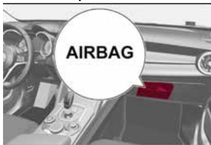
Bolsa de aire para rodillas del pasajero delantero
