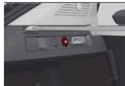
Toma de corriente del área de carga
