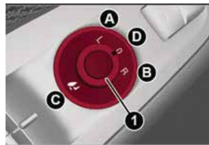
Control eléctrico del espejo
