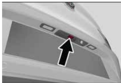
Botón de entrada pasiva en la compuerta levadiza
