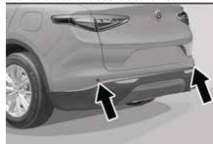
Ubicación del sensor trasero
