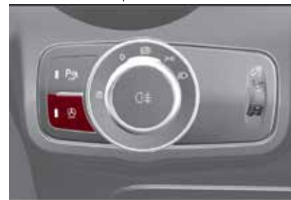
Botón de desactivación del START&STOP
