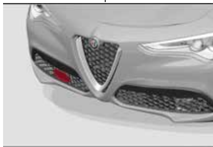
Ubicación del radar en la defensa delantera
