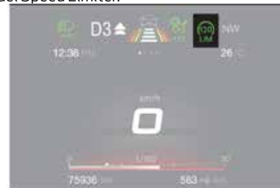
Pantalla del limitador de velocidad
