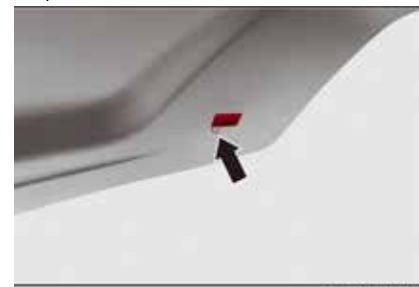
Cable de desbloqueo manual
