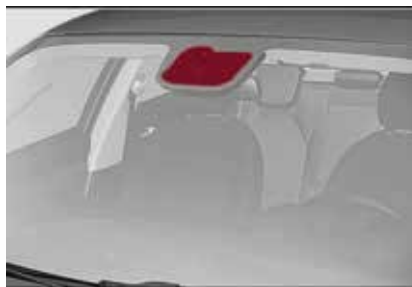
Ubicación de la cámara del parabrisas
