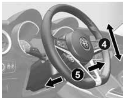
Ajuste del volante
