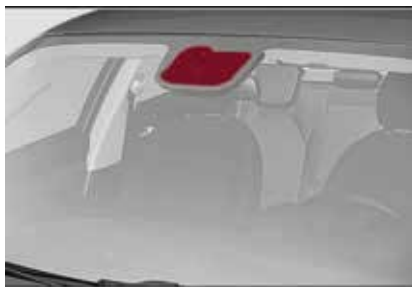
Ubicación de la cámara del parabrisas
