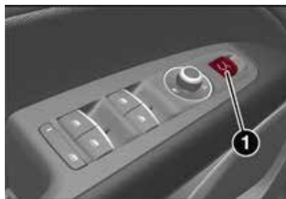
1. Interruptor de liberación de compuerta levadiza
