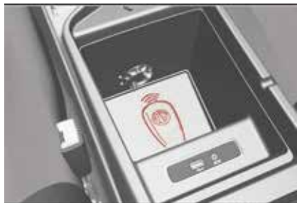
Ubicación para la colocación del transmisor
