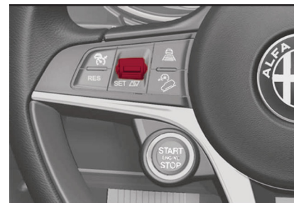
Interruptor SET para velocidad del HDC
