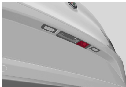
Ubicación de la cámara de reversa
