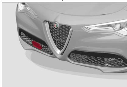
Ubicación del radar en la defensa delantera
