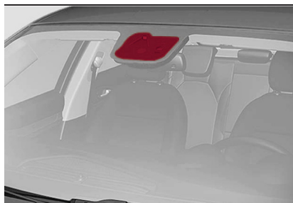
Ubicación de la cámara del parabrisas
