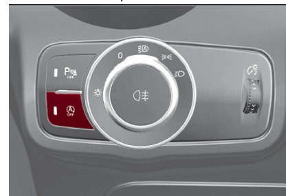
Botón de desactivación del START&STOP
