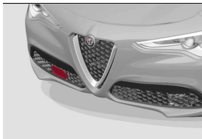
Ubicación del radar en la defensa delantera
