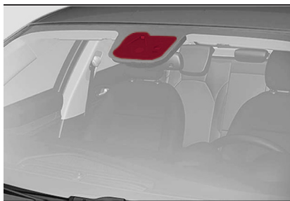
Ubicación de la cámara del parabrisas
