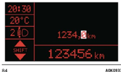
A través del GSI, si está presente, se avisa al conductor de que el cambio de velocidad permitiría una reducción del consumo. Para un manejo orientado al ahorro de combustible, se recomienda por lo tanto mantener la modalidad Natural o All Weather y seguir, cuando las condiciones del tráfico lo permitan, las propuestas del Gear Shift Indicator.
