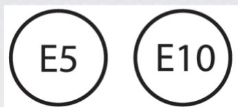
E5: Gasolina sin plomo con máximo 2,7% (m/m) de oxígeno y 5%(V/V) de etanol según norma **EN 228**
