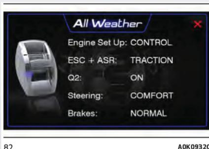
**Sistemas ESC y ASR:** umbrales de intervención que garantizan la máxima seguridad en caso de baja adherencia al conducir. Se recomienda activar la modalidad “AllWeather” cuando se montan las cadenas de nieve.
