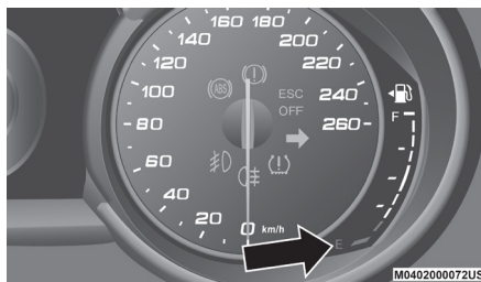
Medidor de nivel de combustible
