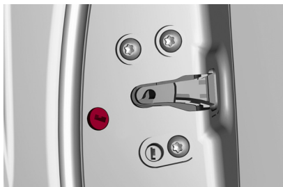
Liberación del cilindro manual de bloqueo de la puerta
