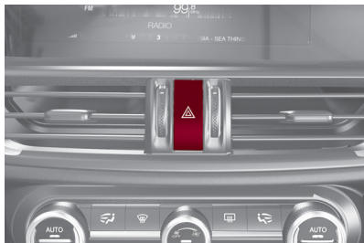
Interruptor de las luces de emergencia
