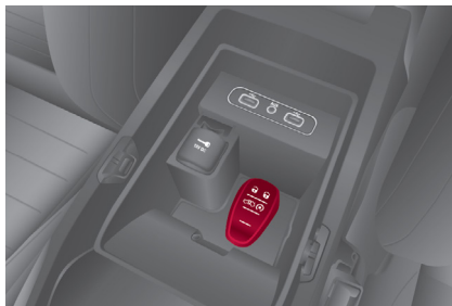
Ubicación para la colocación del transmisor
