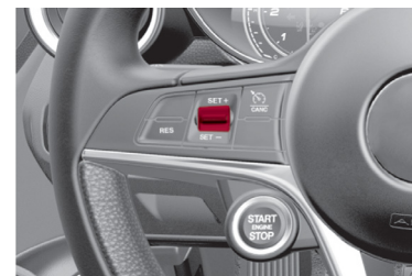
Interruptor SET del control de velocidad electrónico
