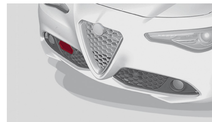
Ubicación del radar en la defensa delantera
