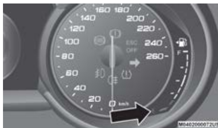
Medidor de nivel de combustible
