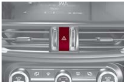
Interruptor de las luces de emergencia
