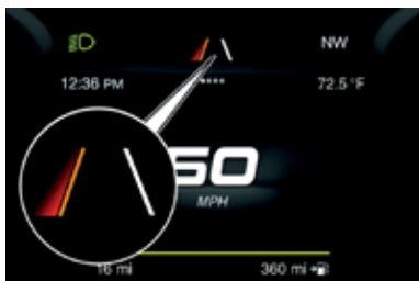
Acercamiento a la línea de carril
