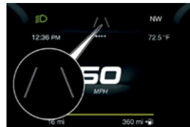
Líneas de carril no detectadas
