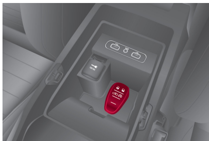
Ubicación para la colocación del transmisor
