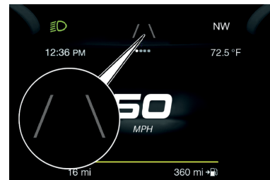
Líneas de carril no detectadas
