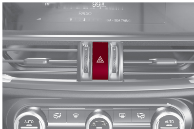
Interruptor de las luces de emergencia
