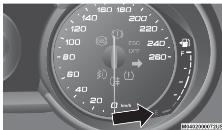
Medidor de nivel de combustible
