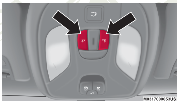
Interruptores de luces de consola superior
